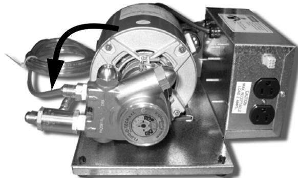
**CARBONATOR PURGE TUBE ROUTING**
