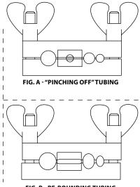
FIG. B - RE-ROUNDING TUBING
