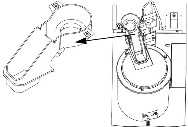
14. La goulotte à glaçons peut être nettoyée en place. Pour la retirer complètement, utiliser un tournevis cruciforme pour retirer l'ensemble de commutateur à effet Hall de la goulotte à glaçons.
