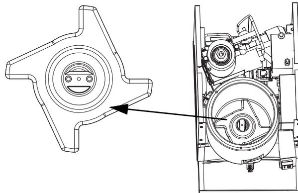
19. Déposer le couvercle du réservoir d'eau.
