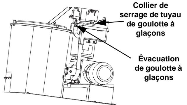
13. Relever la goulotte à glaçons pour la retirer. La goulotte à glaçons doit être retirée avant de pouvoir retirer le couvercle de bac.
