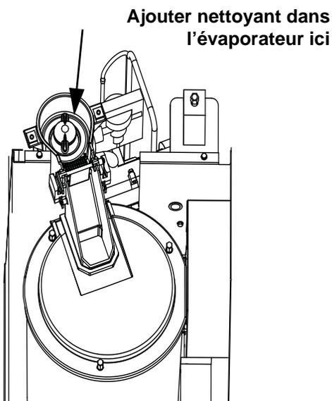
**Étape 3** La machine à glaçons effectuera un cycle de lavage, une série de cycles de rinçage et s'arrêtera. Le cycle complet dure approximativement 30 minutes.
