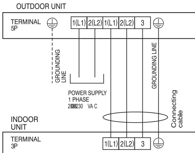
Figure 52: Terminal Block Wiring Diagram LS180HEV1, LS240HEV1
