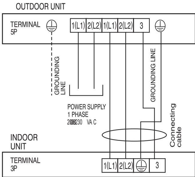
Figure 51: Terminal Block Wiring Diagram LS120HEV1
